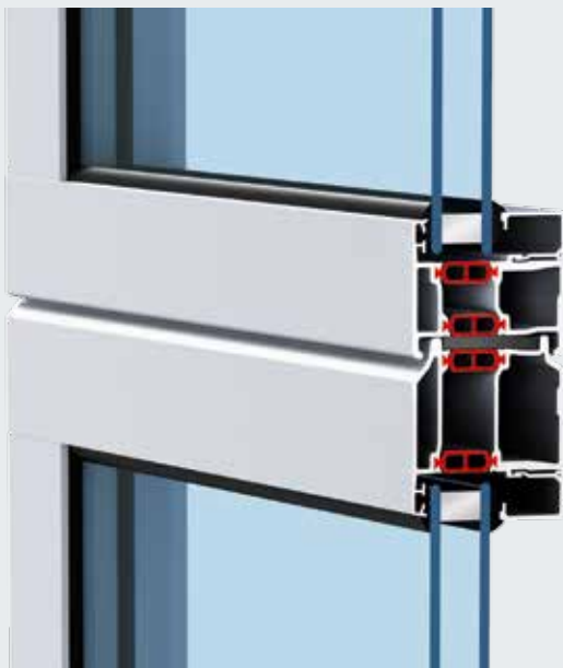
ALR 67 Thermo Glazing s hliníkovými profily s přerušným tepelným mostem
