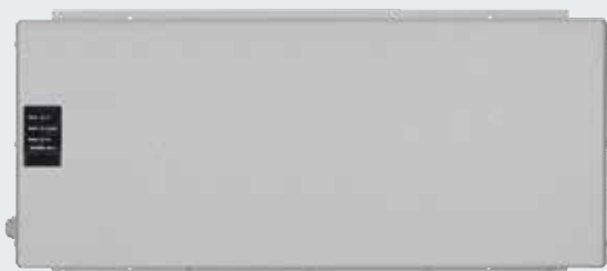
Nepřerušitelný napájecí zdroj USV k překlenutí výpadků napětí do 4 hodin, bezpečnostní zařízení, signální světla atd. zůstávají v provozu, indikace stavu pomocí LED, automatický test baterie, přepětový filtr, rozměry: 560 x 235 x 260 mm (š x v x h), třída ochrany: IP 20
